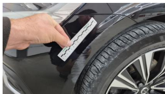
Fot. 40 Zderzak - Rysa/odprysk 1
