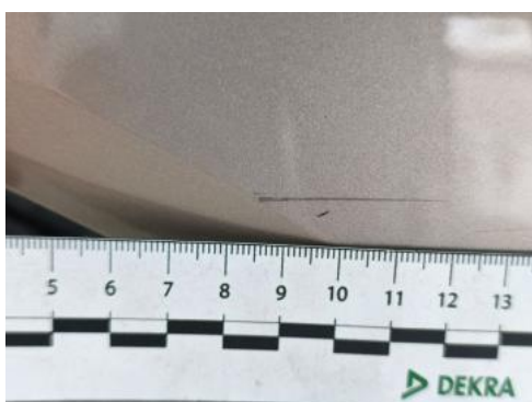
Fot. 47 Zderzak() - Rysa/odprysk 3
