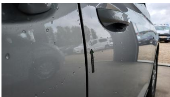
Fot. 51 Drzwi przednie P - Wgniecenie/odkształcenie 1
