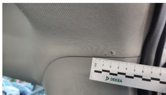
Fot. 68 Podsufitka - Pęknięcie/rozerwanie 1
