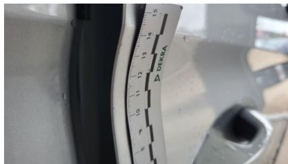
Fot. 50 Drzwi przednie P - Rysa/odprysk 1
