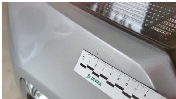
Fot. 49 Zderzak - Rysa/odprysk 1
