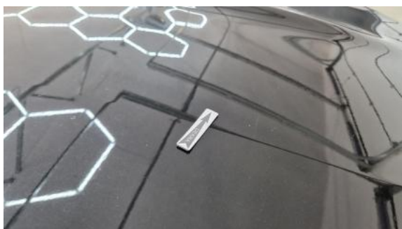
Fot. 37 Pokrywa komory silnika() - Wgniecenie/odkształcenie 3
