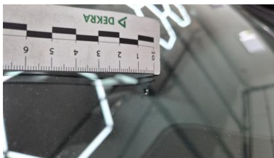
Fot. 38 Szyba czołowa - Pęknięcie/rozerwanie 1
