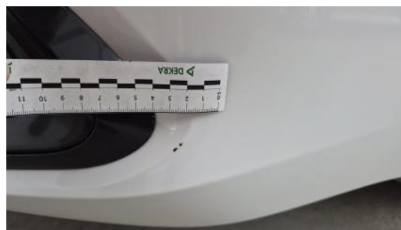
Fot. 38 Zderzak - Rysa/odprysk 1
