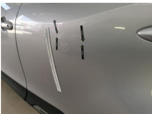
Fot. 51 Drzwi tylne L - Wgniecenie/odkształcenie 1
