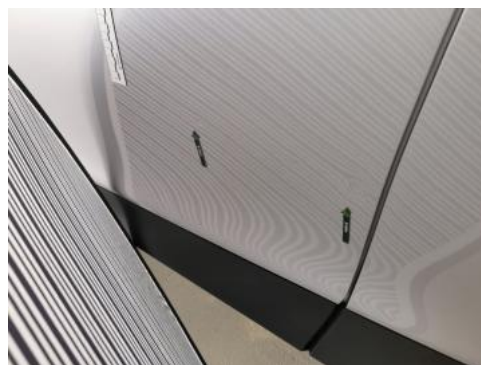
Fot. 50 Drzwi przed L() - Wgniecenie/odkształcenie 3
