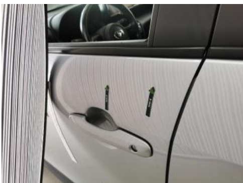
Fot. 49 Drzwi przed L - Wgniecenie/odkształcenie 2
