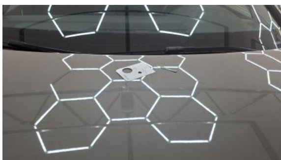
Fot. 39 Pokrywa komory silnika - Wgniecenie/odkształcenie 1
