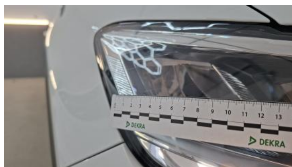
Fot. 40 Reflektor P - Rysa/odprysk 1
