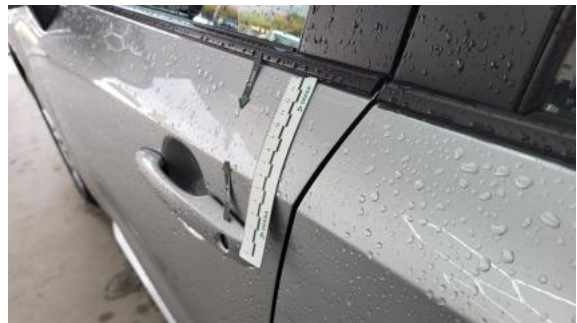
Fot. 50 Drzwi przed L - Wgniecenie/odkształcenie 1
