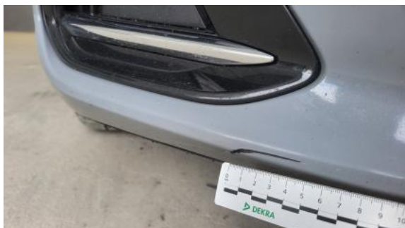
Fot. 49 Zderzak() - Rysa/odprysk 3
