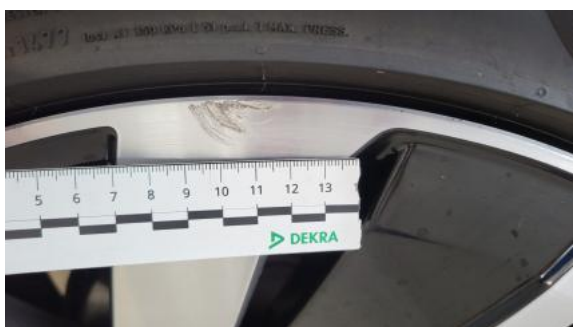
Fot. 51 Felga aluminiowa tylna P - Rysa/odprysk 1
