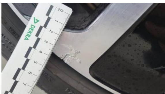
Fot. 55 Felga aluminiowa tylna L - Rysa/odprysk 1
