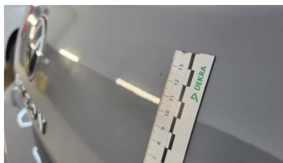
Fot. 52 Pokrywy bagażnika - Rysa/odprysk 1
