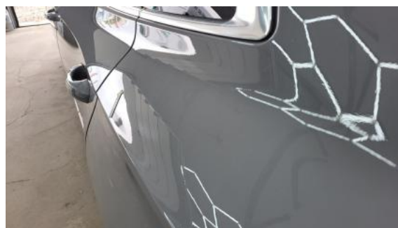
Fot. 54 Błotnik tylny L / Ściana boczna L - Wgniecenie/odkształcenie 1
