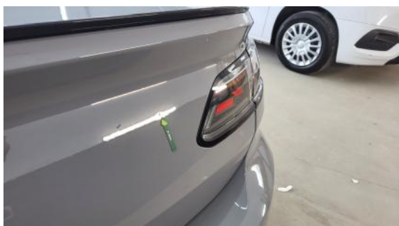
Fot. 53 Pokrywy bagażnika - Wgniecenie/odkształcenie 1
