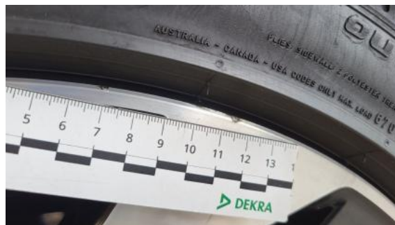
Fot. 50 Felga aluminiowa przednia P - Rysa/odprysk 1
