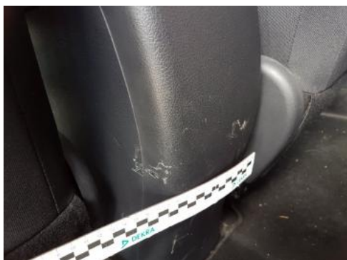
Fot. 45 Konsola środkowa (Rysa/Odprysk)
