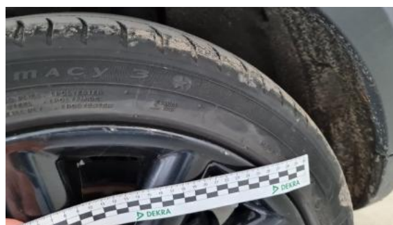
Fot. 44 Felga tylna lewa (Rysa/Odprysk)
