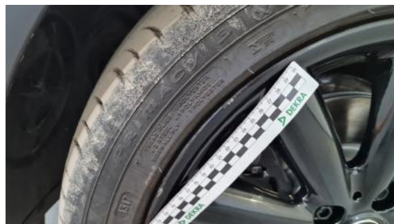
Fot. 50 Felga przednia lewa (Rysa/Odprysk)
