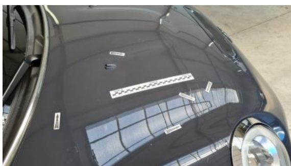
Fot. 27 Pokrywa komory silnika (Wgniec./Odształ.)
