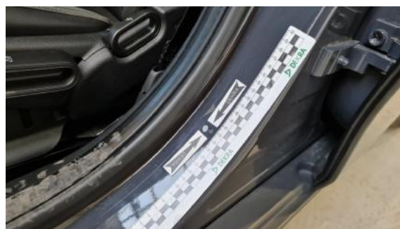
Fot. 46 Słupek środkowy lewy (Wgniec./Odształ.)
