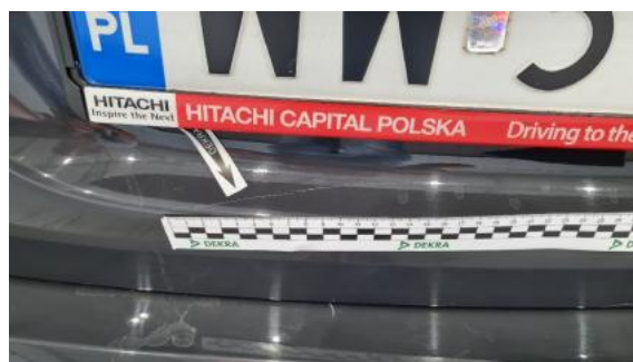
Fot. 40 Pokrywa bagażnika (Rysa/Odprysk)
