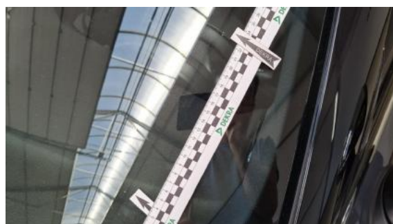
Fot. 28 Szyba czołowa (Rysa/Odprysk)
