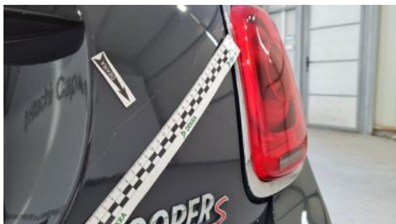
Fot. 41 Pokrywa bagażnika (Rysa/Odprysk 1)
