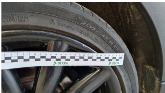
Fot. 33 Felga tylna prawa (Rysa/Odprysk)
