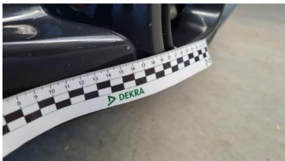
Fot. 25 Zderzak (Rysa/Odprysk)
