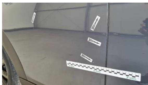
Fot. 32 Drzwi tylne prawe (Rysa/Odprysk)
