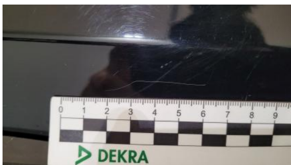
Fot. 53 Drzwi przed L - Rysa/odprysk 1
