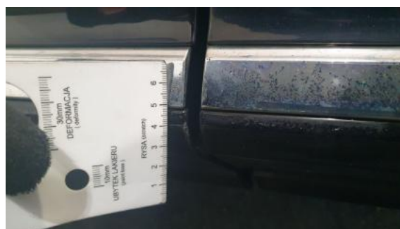
Fot. 56 Listwa drzwi przednich L - Rysa/odprysk 1
