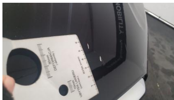
Fot. 38 Pokrywa komory silnika - Wgniecenie/odkształcenie 1
