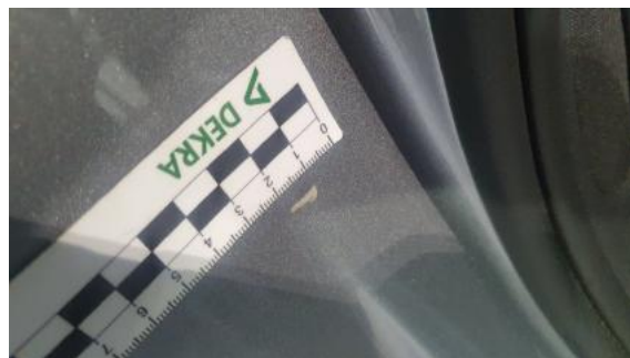
Fot. 26 Błotnik tylny prawy/ściana boczna prawa (Rysa/Odprysk)
