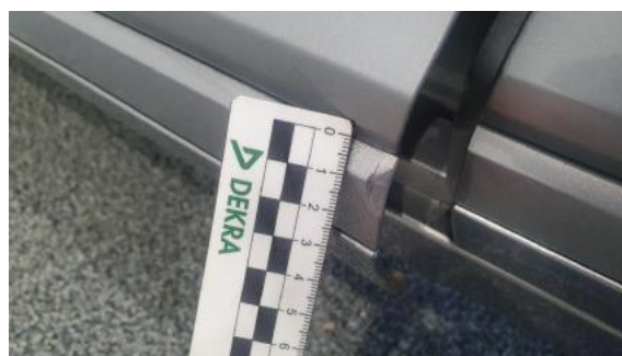
Fot. 32 Listwa drzwi przednich lewych (Wgniecie./Odształ.)
