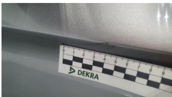
Fot. 31 Drzwi przednie lewe (Rysa/Odprysk)
