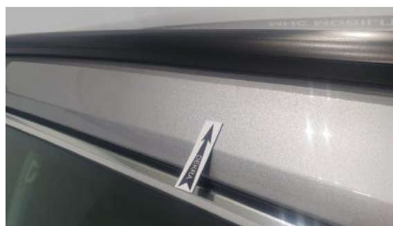
Fot. 28 Rama dachu L (Wgniecie./Odształ.)
