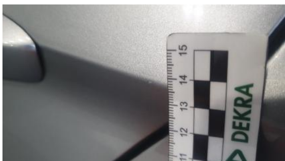
Fot. 29 Drzwi tylne lewe (Rysa/Odprysk)
