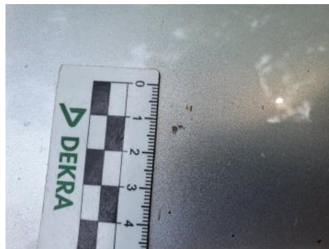
Fot. 26 Pokrywa komory silnika (Rysa/Odprysk)
