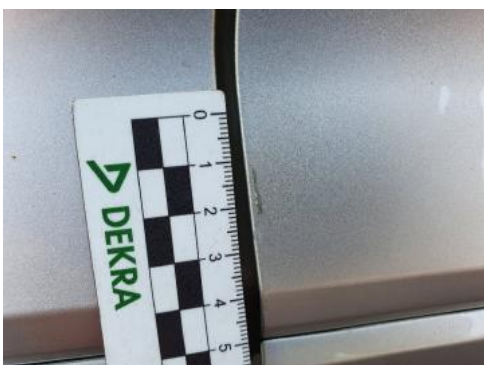
Fot. 27 Drzwi przednie prawe (Rysa/Odprysk)
