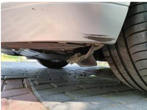
Fot. 25 Spoiler zderzaka przedniego (Rysa/Odprysk)
