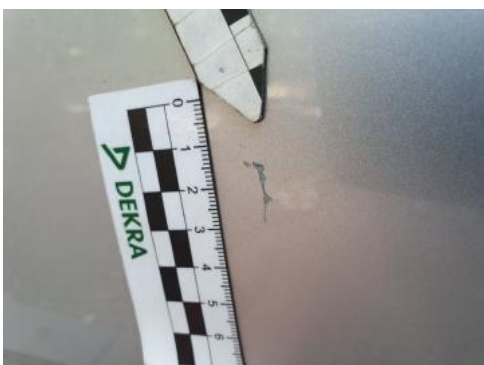
Fot. 31 Drzwi przednie lewe (Rysa/Odprysk)
