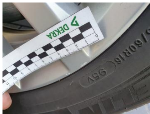
Fot. 30 Felga tylna lewa (Rysa/Odprysk)
