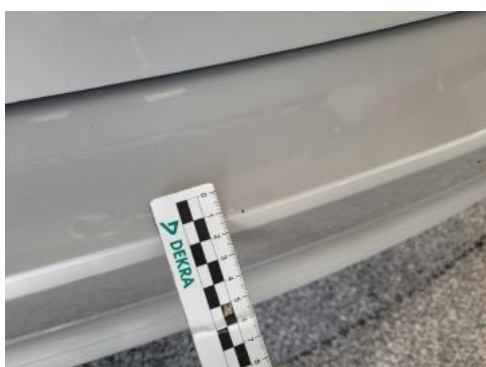
Fot. 27 Zderzak tylny (Rysa/Odprysk)
