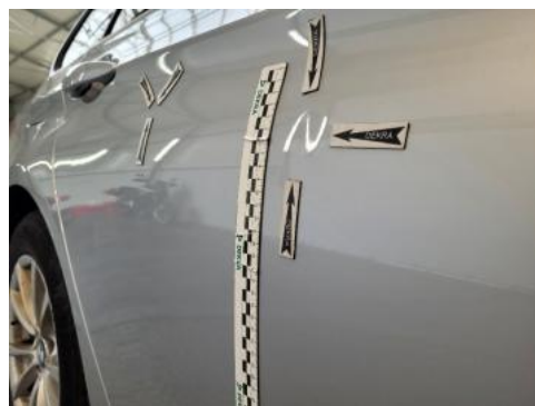
Fot. 26 Drzwi tylne prawe (Wgniecie./Odształ.)
