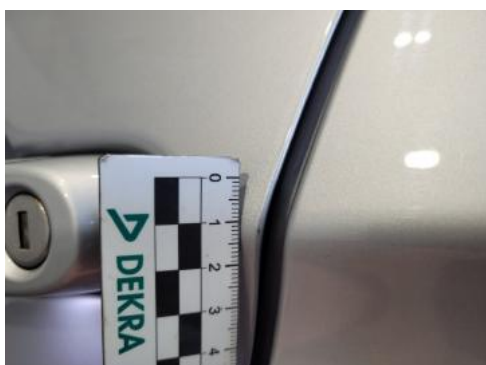
Fot. 29 Drzwi przednie lewe (Rysa/Odprysk)
