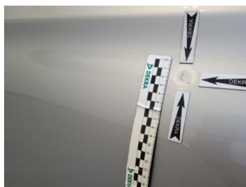
Fot. 28 Drzwi tylne lewe (Wgniecie./Odształ.)
