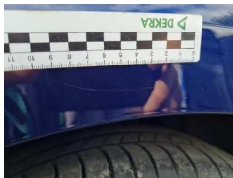
Fot. 56 Błotnik tylny lewy/ściana boczna lewa (Rysa/Odprysk 1)
