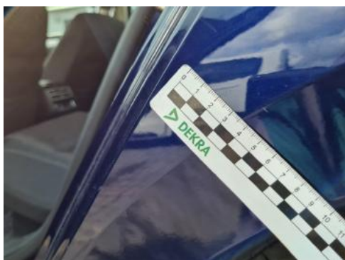
Fot. 55 Błotnik tylny lewy/ściana boczna lewa (Rysa/Odprysk)
