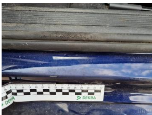
Fot. 61 Próg lewy (Rysa/Odprysk)
