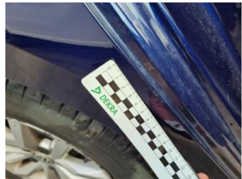
Fot. 44 Błotnik tylny prawy/ściana boczna prawa (Rysa/Odprysk 1)
