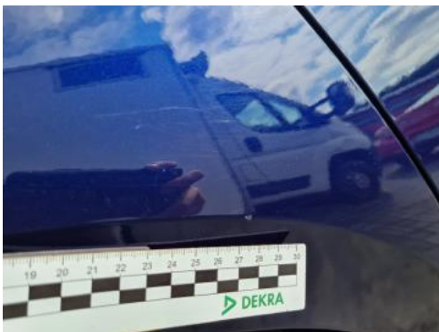
Fot. 45 Błotnik tylny prawy/ściana boczna prawa (Rysa/Odprysk 2)
