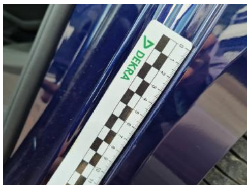
Fot. 57 Błotnik tylny lewy/ściana boczna lewa (Rysa/Odprysk 2)
