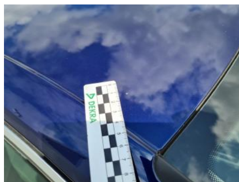
Fot. 52 Dach (Rysa/Odprysk)
