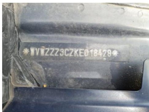
Fot. 7 Pole numerowe
