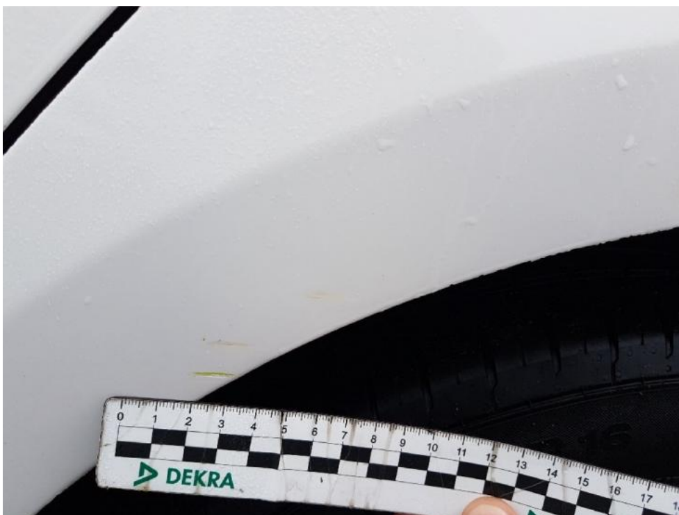
Fot. 34. Błotnik tylny lewy/ściana boczna lewa (Rysa/Odprysk)
