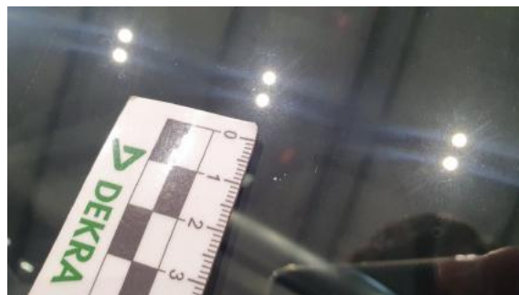
Fot. 26 Szyba czołowa (Rysa/Odprysk)
