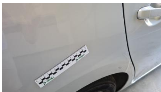
Fot. 32 Błotnik tylny prawy/ściana boczna prawa (Rysa/Odprysk)
