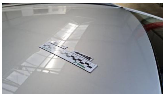
Fot. 36 Dach (Wgniec./Odształ.)
