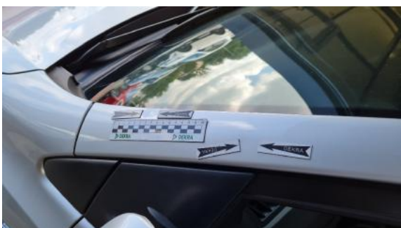
Fot. 37 Rama dachu L (Wgniec./Odształ.)
