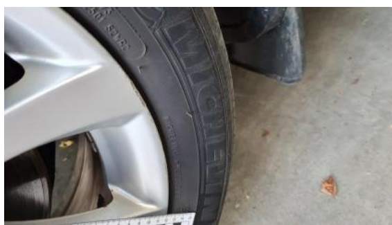
Fot. 40 Felga przednia lewa (Rysa/Odprysk)
