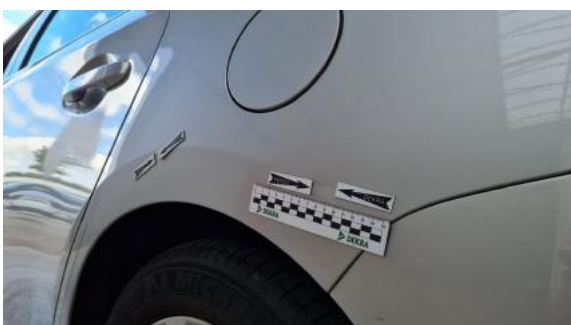
Fot. 39 Błotnik tylny lewy/ściana boczna lewa (Wgniec./Odształ.)
