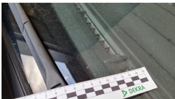
Fot. 29 Szyba czołowa (Rysa/Odprysk)
