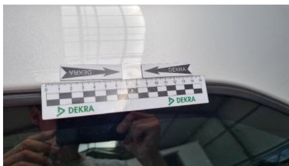
Fot. 38 Rama dachu L (Wgniec./Odształ. 1)
