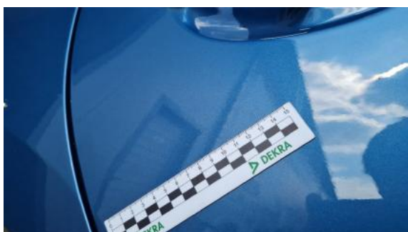
Fot. 31 Drzwi tylne prawe (Rysa/Odprysk)
