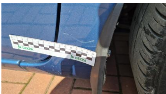
Fot. 27 Błotnik przedni prawy (Rysa/Odprysk)
