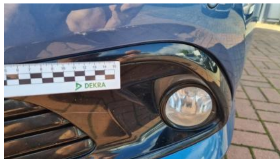
Fot. 26 Zderzak (Rysa/Odprysk)
