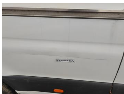
Fot. 60 Błotnik tylny P / Ściana boczna P - Rysa/odprysk 1
