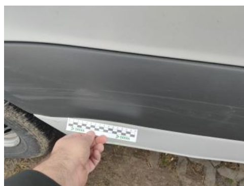
Fot. 92 Błotnik tylny L / Ściana boczna L - Rysa/odprysk 2
