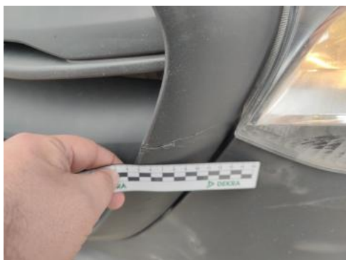
Fot. 33 Atrapa przednia - Pęknięcie/rozerwanie 1
