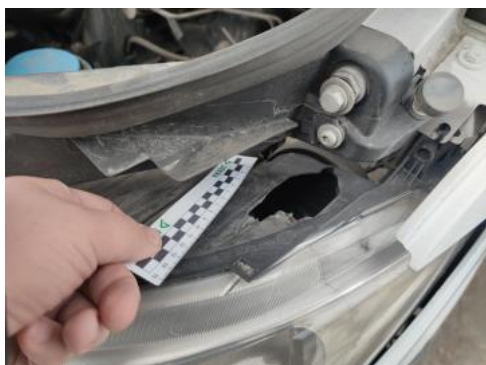
Fot. 105 Reflektor L - Pęknięcie/rozerwanie 1
