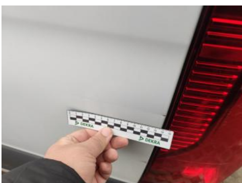
Fot. 91 Błotnik tylny L / Ściana boczna L - Rysa/odprysk 1
