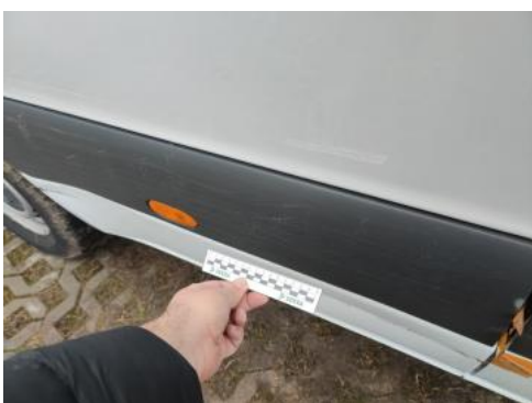
Fot. 61 Błotnik tylny P / Ściana boczna P - Rysa/odprysk 2
