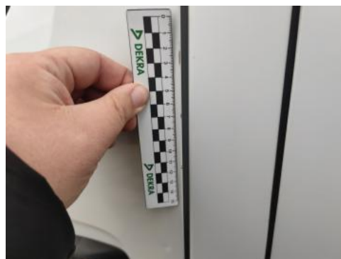
Fot. 98 Drzwi przed L - Rysa/odprysk 1
