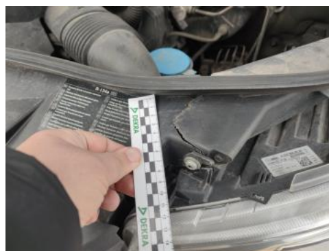
Fot. 40 Wzmocnienie czołowe - Pęknięcie/rozerwanie 1
