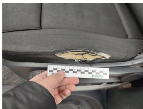
Fot. 110 Fotel prz. lew. - Pęknięcie/rozerwanie 1
