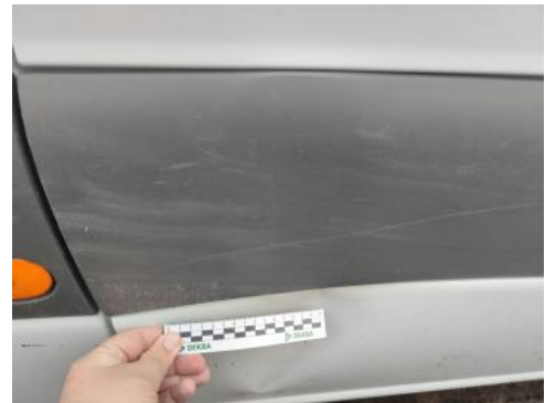
Fot. 50 Drzwi przednie P - Rysa/odprysk 1
