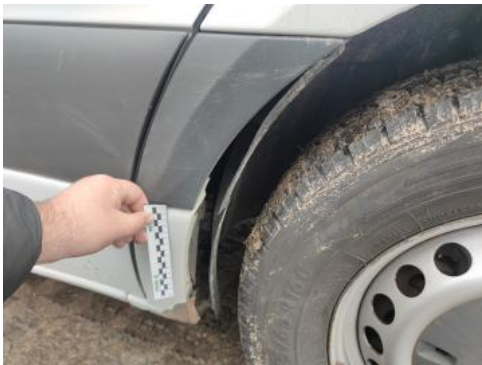
Fot. 49 Nadkole przednie P - Pęknięcie/rozerwanie 1
