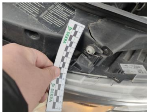
Fot. 106 Reflektor L - Pęknięcie/rozerwanie 2
