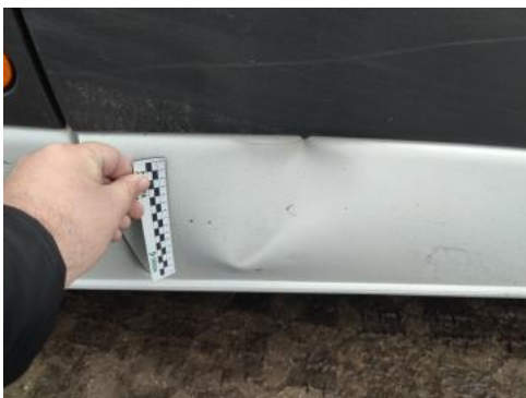
Fot. 51 Drzwi przednie P - Wgniecenie/odkształcenie 1
