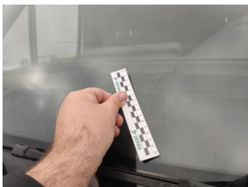
Fot. 39 Szyba czołowa - Pęknięcie/rozerwanie 1
