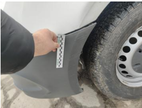
Fot. 43 Zderzak - Rysa/odprysk 2
