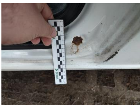
Fot. 103 Próg L - Wgniecenie/odkształcenie 1
