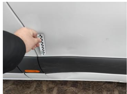
Fot. 52 Drzwi przednie P - Wgniecenie/odkształcenie 2
