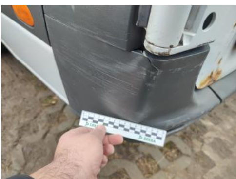
Fot. 87 Zderzak tylny cz L - Rysa/odprysk 1
