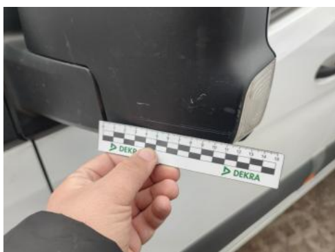
Fot. 101 Lusterko zew L - Rysa/odprysk 1
