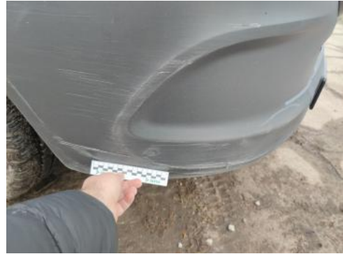
Fot. 42 Zderzak - Rysa/odprysk 1
