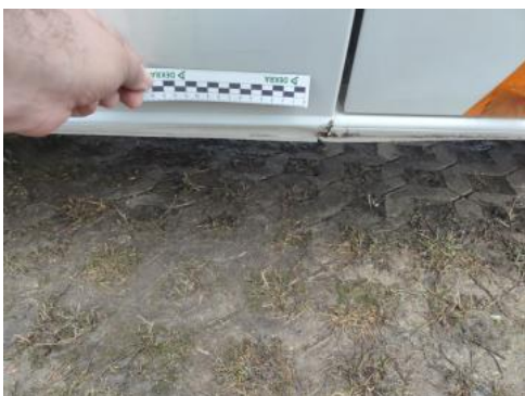
Fot. 57 Próg P - Wgniecenie/odkształcenie 1
