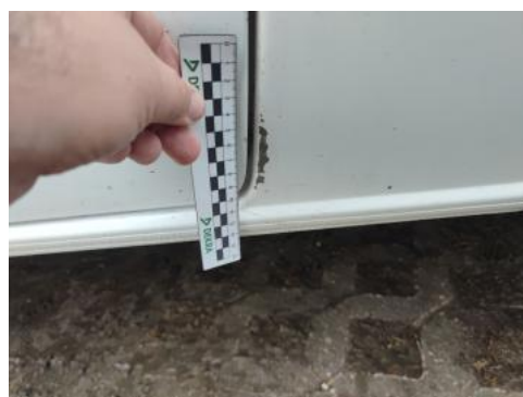
Fot. 102 Próg L - Rysa/odprysk 1
