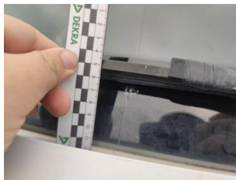
Fot. 38 Szyba czołowa - Rysa/odprysk 2
