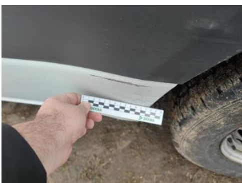
Fot. 93 Błotnik tylny L / Ściana boczna L() - Rysa/odprysk 3
