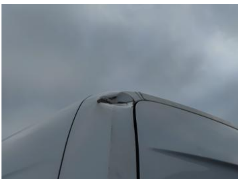
Fot. 89 Dach - Wgniecenie/odkształcenie 1
