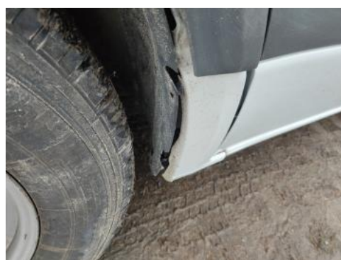
Fot. 104 Nadkole przednie L - Pęknięcie/rozerwanie 1
