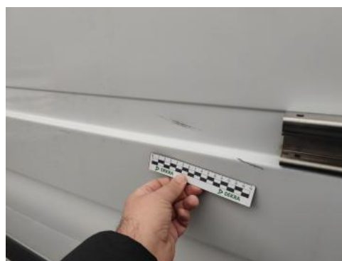
Fot. 62 Błotnik tylny P / Ściana boczna P() - Rysa/odprysk 3
