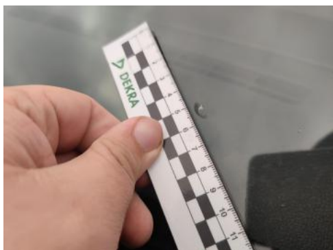
Fot. 37 Szyba czołowa - Rysa/odprysk 1
