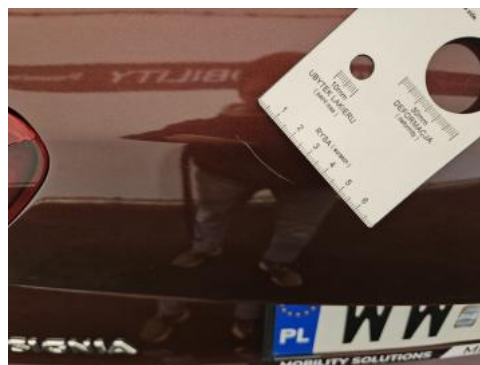
Fot. 42 Pokrywy bagażnika - Rysa/odprysk 1
