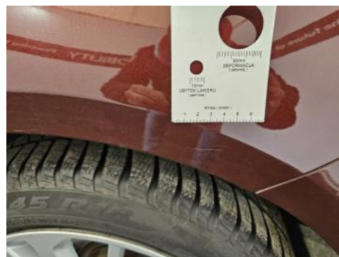
Fot. 50 Błotnik tylny L / Ściana boczna L - Rysa/odprysk 1
