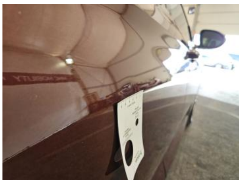
Fot. 41 Drzwi tylne P - Wgniecenie/odkształcenie 1
