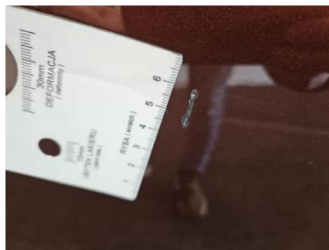
Fot. 38 Drzwi przednie P - Rysa/odprysk 1
