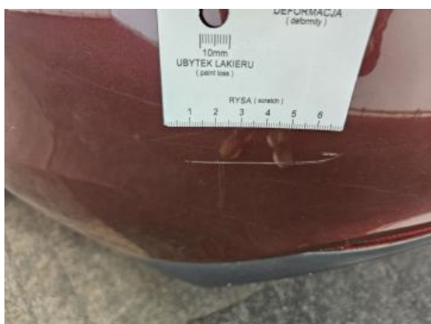
Fot. 45 Zderzak tylny - Rysa/odprysk 1
