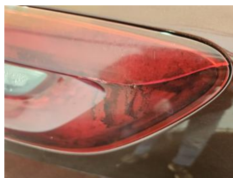
Fot. 52 Lampa tylna wew L - Pęknięcie/rozerwanie 1
