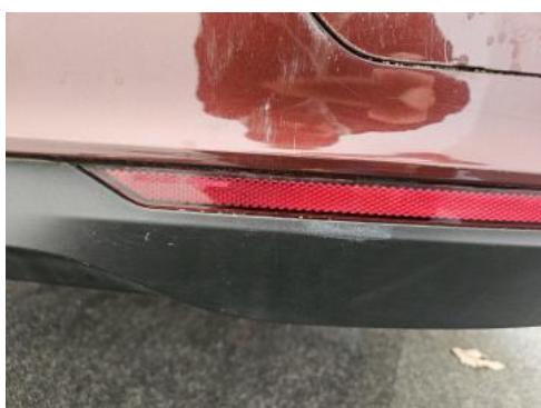
Fot. 47 Zderzak tylny() - Rysa/odprysk 3
