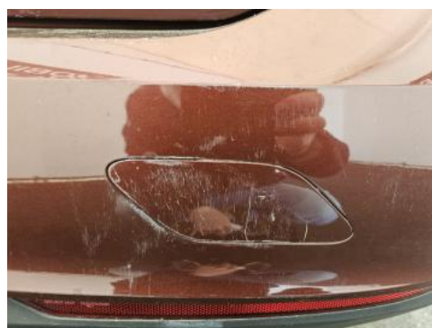
Fot. 46 Zderzak tylny - Rysa/odprysk 2
