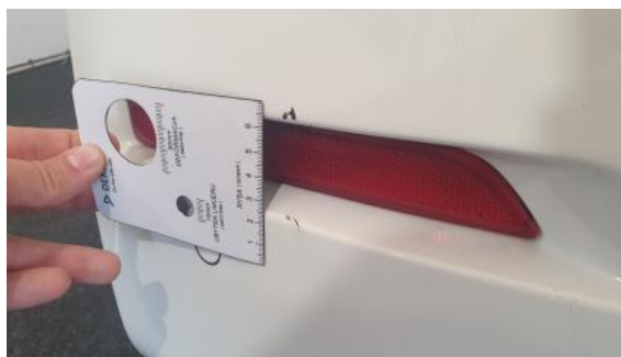
Fot. 48 Zderzak tylny - Wgniecenie/odkształcenie 2
