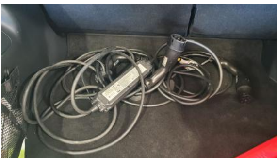
Fot. 27 Przewód ładowania baterii trakcyjnej
