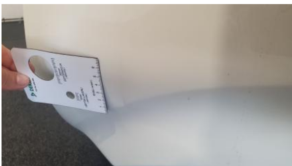
Fot. 47 Zderzak tylny - Wgniecenie/odkształcenie 1
