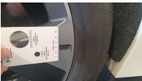
Fot. 43 Felga aluminiowa tylna P - Rysa/odprysk 1
