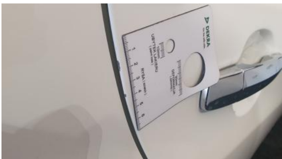
Fot. 41 Drzwi tylne P - Rysa/odprysk 2
