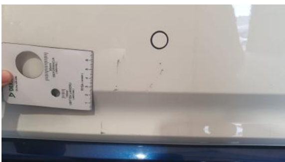
Fot. 45 Zderzak tylny - Rysa/odprysk 2
