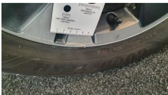
Fot. 39 Felga aluminiowa przednia P - Rysa/odprysk 1
