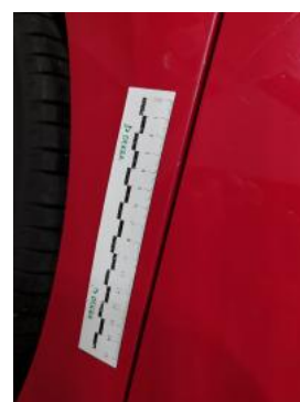
Fot. 36 Błotnik tylny P / Ściana boczna P - Rysa/odprysk 1
