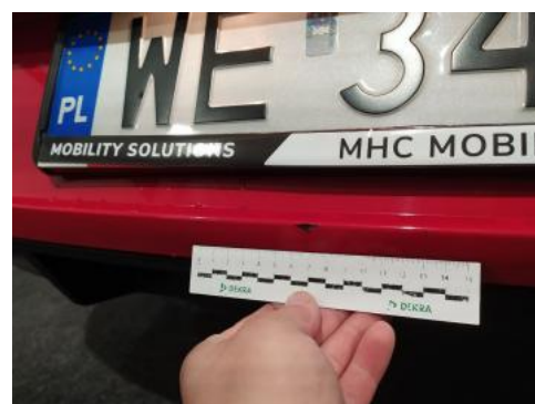
Fot. 40 Zderzak tylny cz dolna - Rysa/odprysk 1
