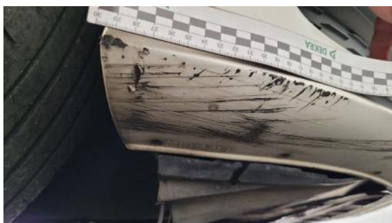
Fot. 37 Zderzak przedni cz dolna - Rysa/odprysk 1
