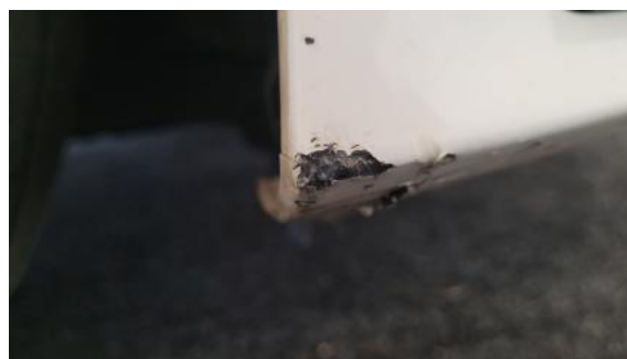
Fot. 38 Zderzak przedni cz dolna - Rysa/odprysk 2
