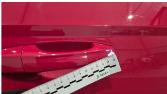
Fot. 41 Klamka drzwi prz P - Rysa/odprysk 1
