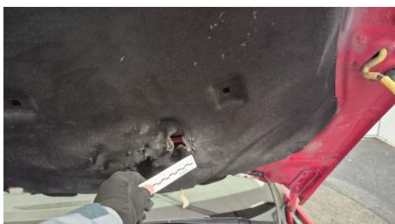
Fot. 39 Wykładzina pokrywy komory silnika - Pęknięcie/rozerwanie 1
