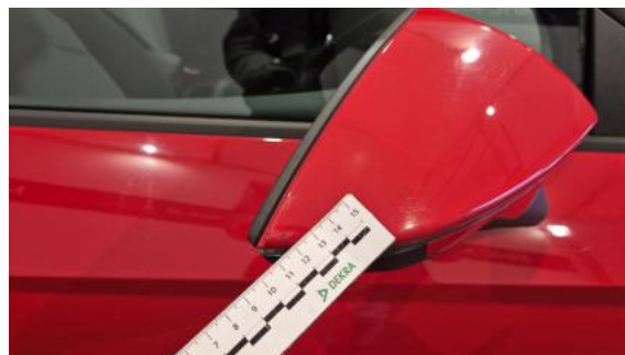
Fot. 42 Lusterko zew P - Rysa/odprysk 1
