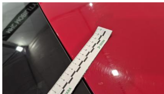
Fot. 46 Dach - Rysa/odprysk 1
