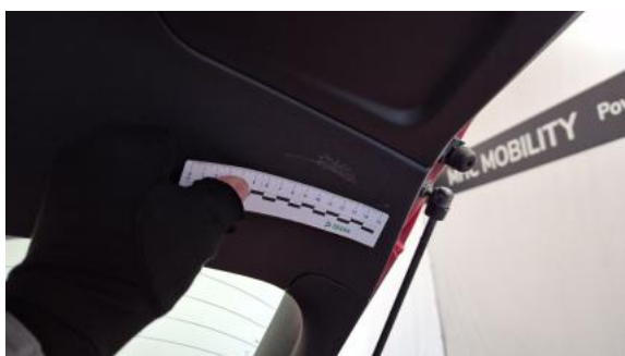
Fot. 51 Wykładzina pokrywy tylnej - Rysa/odprysk 1
