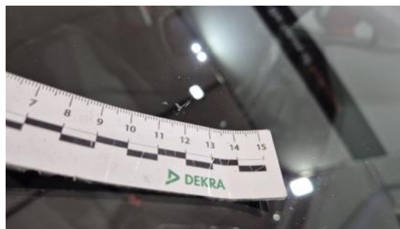
Fot. 38 Szyba czołowa - Pęknięcie/rozerwanie 1
