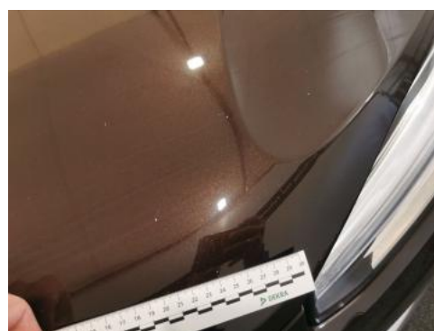
Fot. 40 Pokrywa komory silnika - Rysa/odprysk 1
