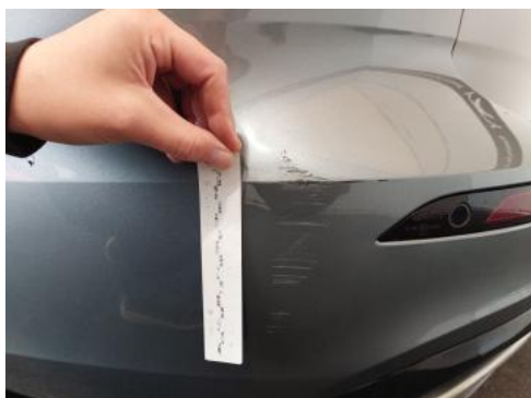
Fot. 45 Zderzak tylny cz L - Rysa/odprysk 2
