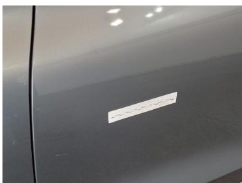
Fot. 51 Drzwi tylne L - Rysa/odprysk 1
