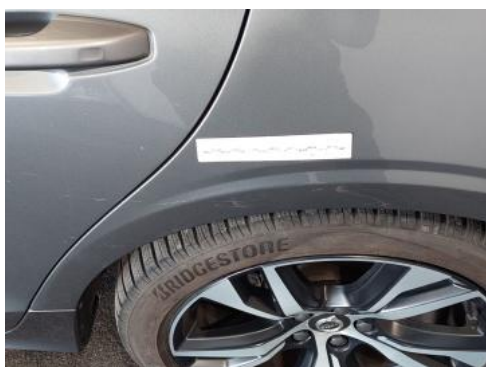
Fot. 47 Błotnik tylny L / Ściana boczna L - Rysa/odprysk 1
