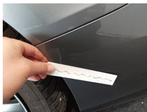
Fot. 44 Zderzak tylny cz L - Rysa/odprysk 1
