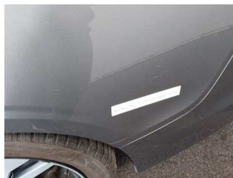
Fot. 48 Błotnik tylny L / Ściana boczna L - Rysa/odprysk 2
