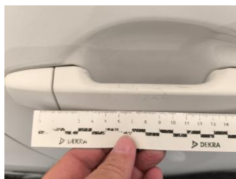
Fot. 44 Klamka drzwi tyl P - Rysa/odprysk 1
