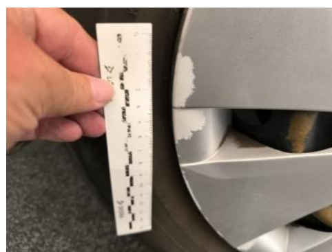
Fot. 48 Kołpak tylny P() - Rysa/odprysk 3
