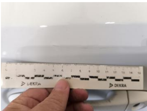
Fot. 59 Drzwi przed L - Rysa/odprysk 1
