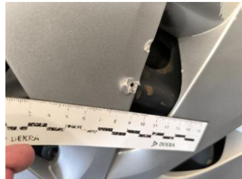
Fot. 58 Kołpak tylny L - Pęknięcie/rozerwanie 1
