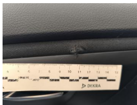
Fot. 68 Tapicerka drzwi tylnych L - Pęknięcie/rozerwanie 1
