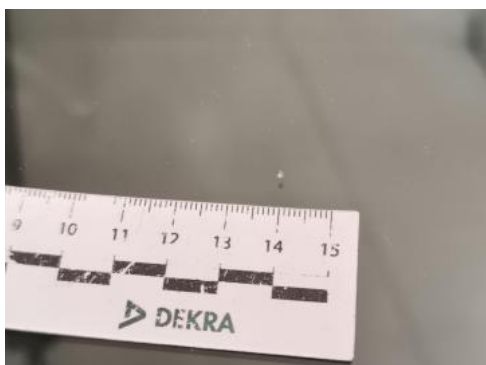
Fot. 39 Szyba czołowa - Rysa/odprysk 1
