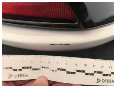
Fot. 50 Zderzak tylny - Rysa/odprysk 1
