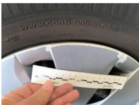
Fot. 67 Kołpak przedni L() - Rysa/odprysk 3
