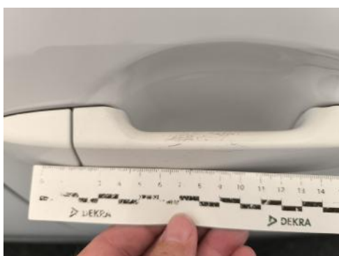
Fot. 43 Klamka drzwi prz P - Rysa/odprysk 1
