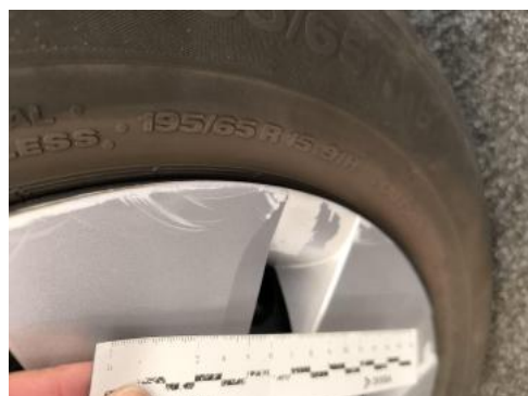
Fot. 40 Kołpak przedni P - Rysa/odprysk 1
