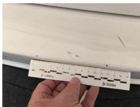
Fot. 52 Zderzak tylny() - Rysa/odprysk 3
