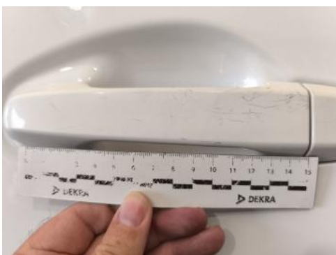
Fot. 63 Klamka drzwi tyl L - Rysa/odprysk 1
