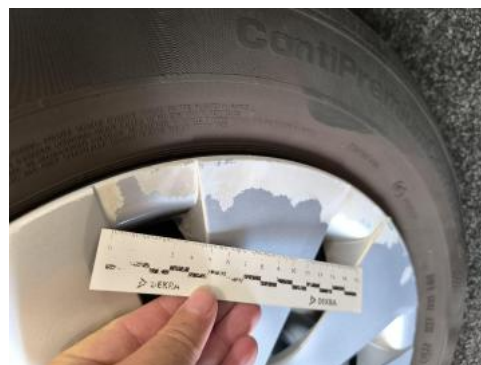
Fot. 66 Kołpak przedni L - Rysa/odprysk 1
