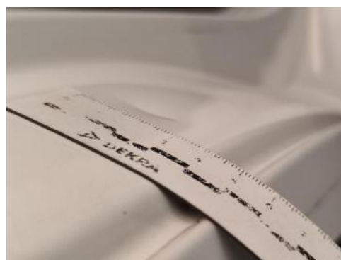
Fot. 46 Próg P - Wgniecenie/odkształcenie 1
