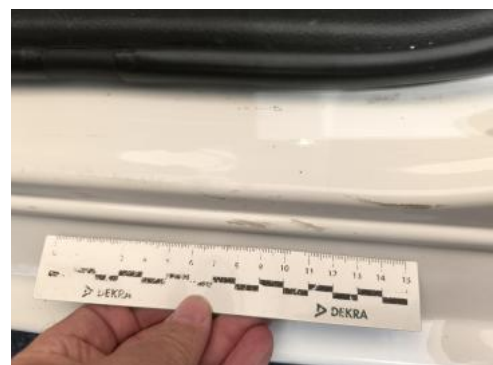
Fot. 64 Próg L - Rysa/odprysk 1
