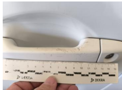
Fot. 62 Klamka drzwi prz L - Rysa/odprysk 1
