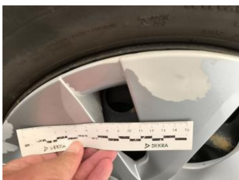
Fot. 47 Kołpak tylny P - Rysa/odprysk 1
