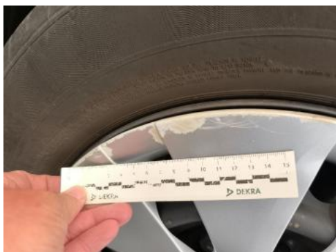
Fot. 41 Kołpak przedni P() - Rysa/odprysk 3
