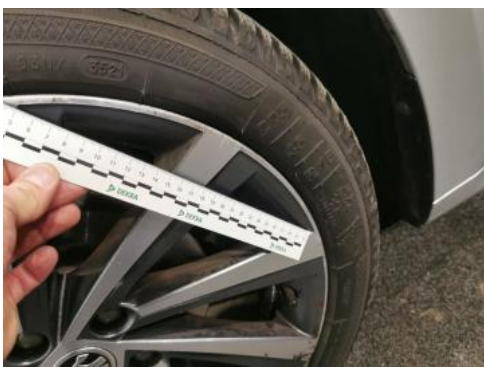
Fot. 53 Felga Aluminiowa przednia L - Rysa/odprysk 2
