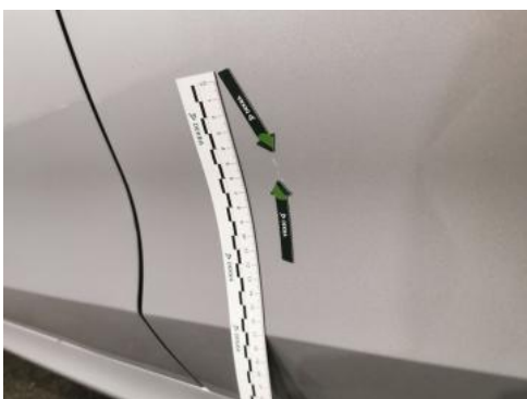
Fot. 51 Drzwi tylne L - Wgniecenie/odkształcenie 1
