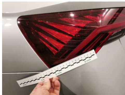
Fot. 50 Lampa tylna zew L - Rysa/odprysk 1
