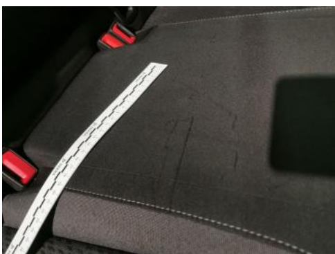
Fot. 55 Kanapa tyl. - Rysa/odprysk 1
