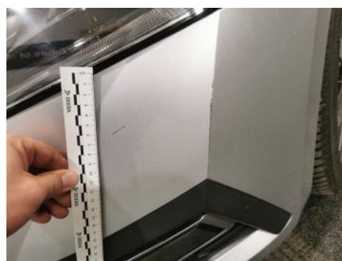
Fot. 40 Zderzak - Rysa/odprysk 1
