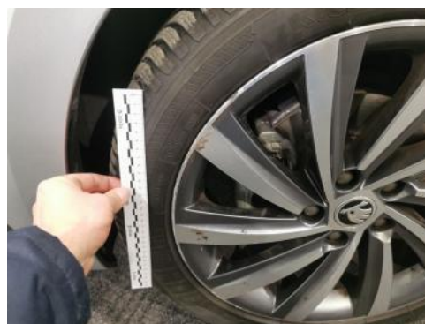
Fot. 52 Felga Aluminiowa przednia L - Rysa/odprysk 1
