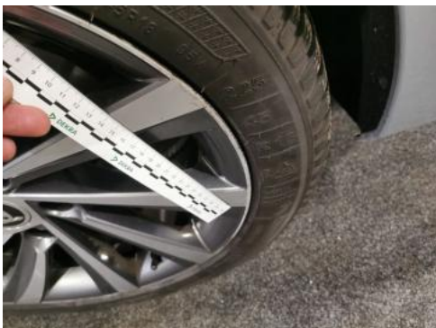
Fot. 49 Felga aluminiowa tylna L - Rysa/odprysk 1
