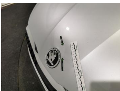
Fot. 39 Pokrywa komory silnika - Wgniecenie/odkształcenie 1
