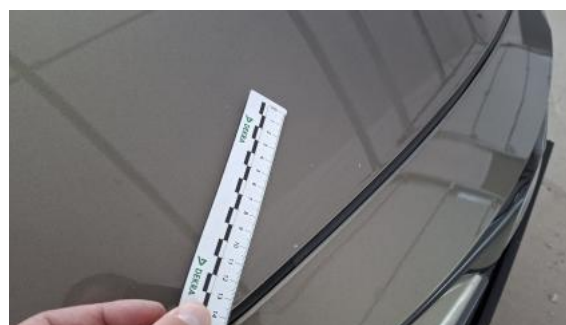
Fot. 40 Pokrywa komory silnika - Rysa/odprysk 1
