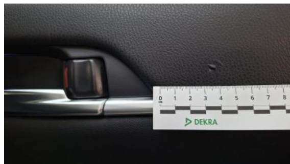
Fot. 66 Tapicerka drzwi tylnych P - Pęknięcie/rozerwanie 1
