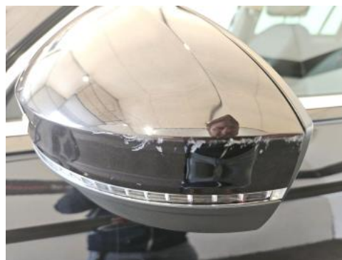
Fot. 54 Lusterko zew L - Rysa/odprysk 1
