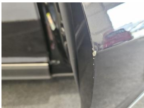
Fot. 41 Drzwi przednie P - Rysa/odprysk 1
