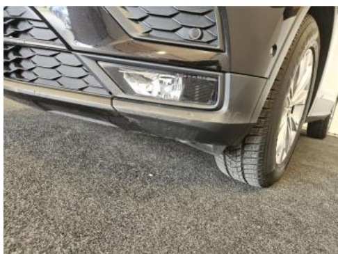
Fot. 39 Zderzak - Rysa/odprysk 2
