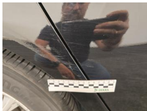
Fot. 54 Drzwi tylne P - Rysa/odprysk 2
