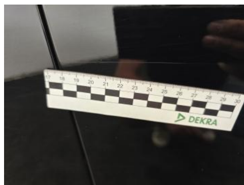
Fot. 52 Drzwi przednie P() - Rysa/odprysk 3
