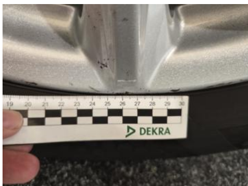
Fot. 49 Felga aluminiowa przednia P - Rysa/odprysk 1
