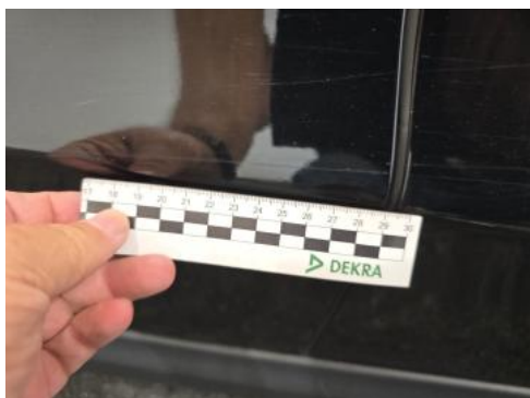
Fot. 53 Drzwi tylne P - Rysa/odprysk 1
