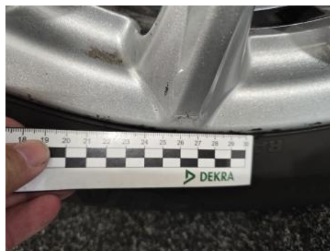
Fot. 50 Felga aluminiowa przednia P() - Rysa/odprysk 3
