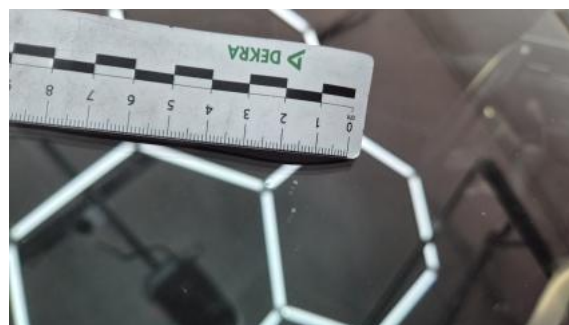
Fot. 38 Szyba czołowa - Rysa/odprysk 1
