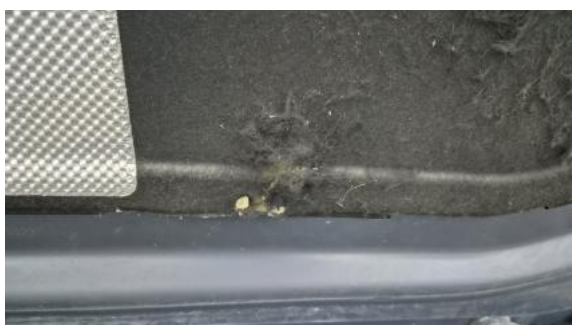
Fot. 39 Wykładzina pokrywy komory silnika - Pęknięcie/rozerwanie 1
