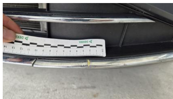
Fot. 40 Zderzak - Wgniecenie/odkształcenie 1
