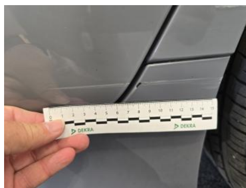
Fot. 54 Drzwi tylne L - Rysa/odprysk 2
