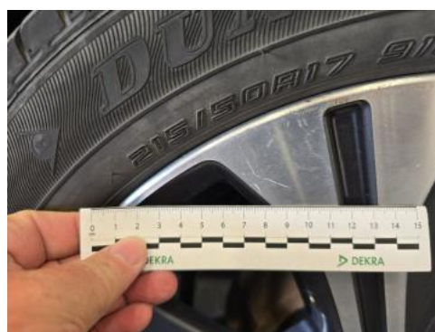
Fot. 52 Felga aluminiowa tylna L - Rysa/odprysk 1
