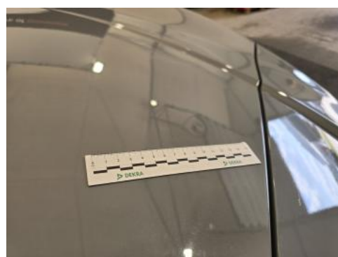
Fot. 40 Pokrywa komory silnika - Wgniecenie/odkształcenie 1
