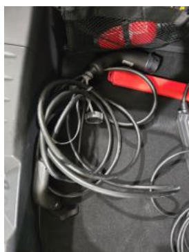
Fot. 27 Przewód ładowania baterii trakcyjnej
