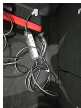
Fot. 28 Stacja ładowania baterii trakcyjnej
