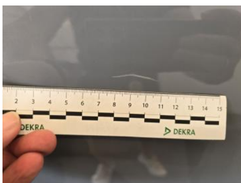
Fot. 55 Drzwi tylne L() - Rysa/odprysk 3
