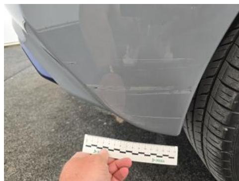
Fot. 50 Zderzak tylny() - Rysa/odprysk 3
