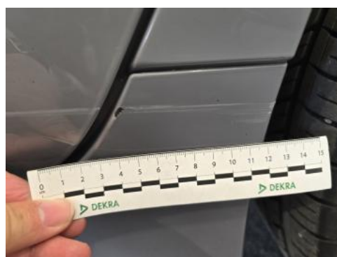
Fot. 56 Próg L - Rysa/odprysk 1
