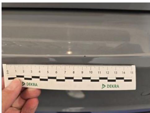
Fot. 49 Zderzak tylny - Rysa/odprysk 2
