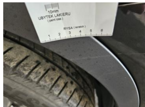
Fot. 38 Listwa krawędzi błotnika prz P - Rysa/odprysk 1
