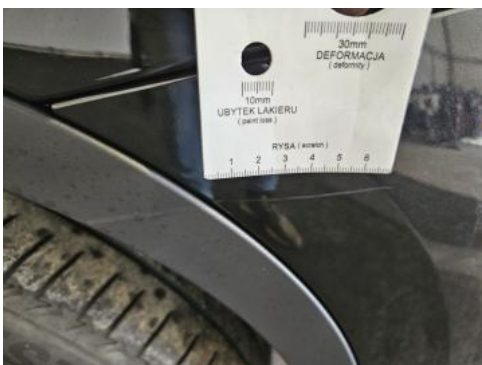
Fot. 37 Zderzak - Rysa/odprysk 1
