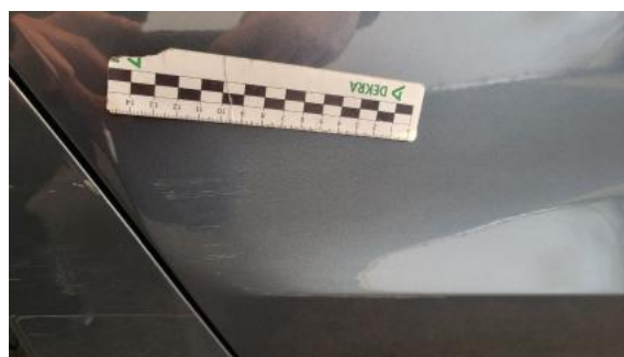
Fot. 36 Drzwi tylne P - Rysa/odprysk 2
