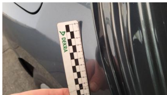
Fot. 38 Błotnik tylny P / Ściana boczna P - Wgniecenie/odkształcenie 1
