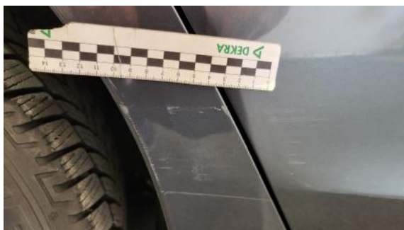
Fot. 37 Błotnik tylny P / Ściana boczna P - Rysa/odprysk 1
