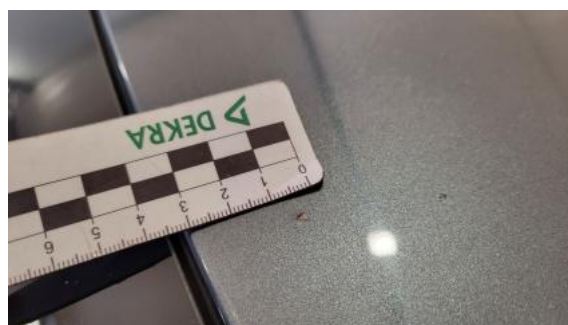
Fot. 40 Dach - Rysa/odprysk 2
