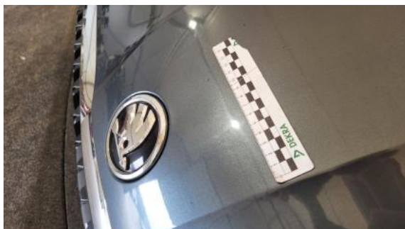
Fot. 33 Pokrywa komory silnika - Wgniecenie/odkształcenie 1
