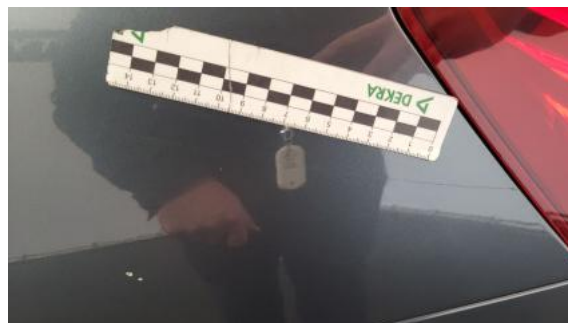
Fot. 42 Błotnik tylny L / Ściana boczna L - Rysa/odprysk 2
