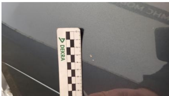
Fot. 41 Błotnik tylny L / Ściana boczna L - Rysa/odprysk 1
