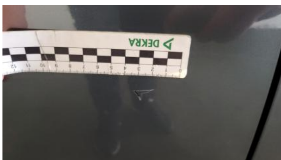
Fot. 35 Drzwi tylne P - Rysa/odprysk 1
