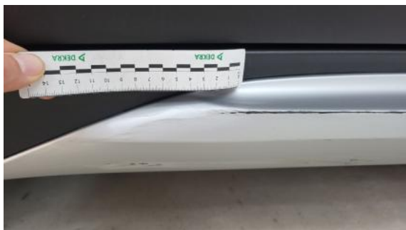
Fot. 41 Próg P - Wgniecenie/odkształcenie 1
