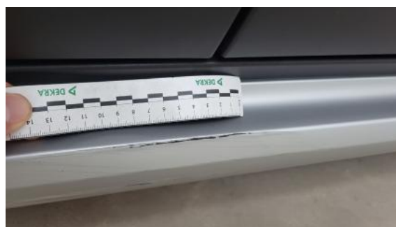
Fot. 40 Próg P - Rysa/odprysk 2
