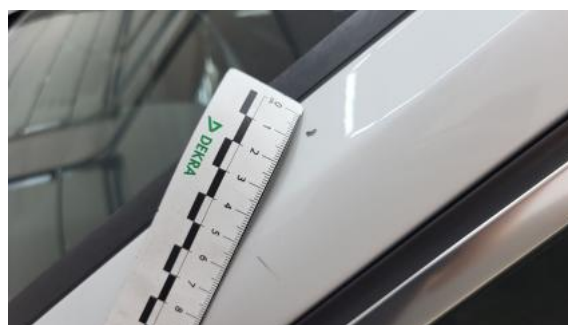
Fot. 48 Stupek przedni L - Rysa/odprysk 1
