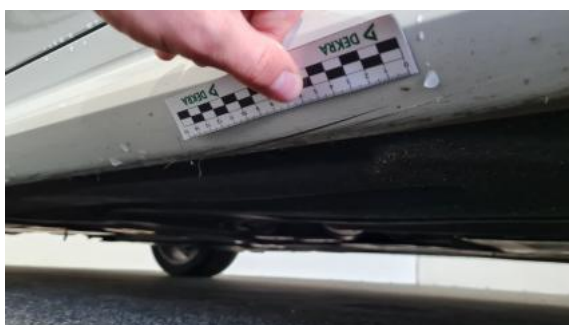
Fot. 43 Próg P - Rysa/odprysk 1
