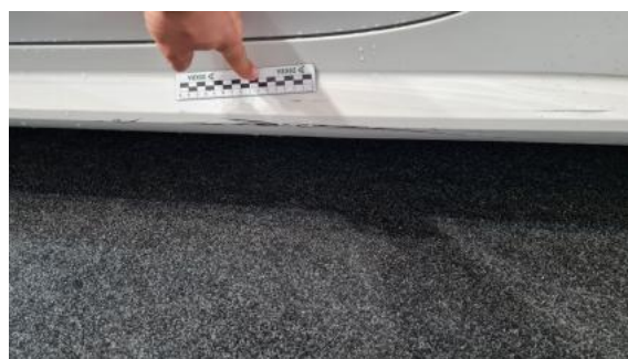
Fot. 48 Próg L - Rysa/odprysk 1
