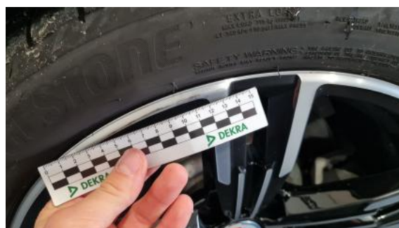
Fot. 44 Felga tylna P - Rysa/odprysk 1
