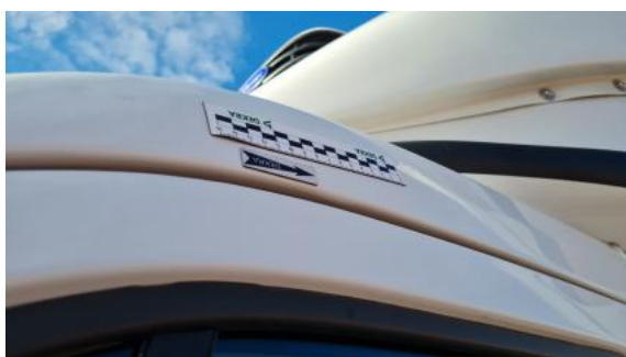
Fot. 39 Słupek przedni L - Wgniecenie/odkształcenie 1
