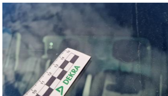
Fot. 38 Szyba czołowa - Rysa/odprysk 1
