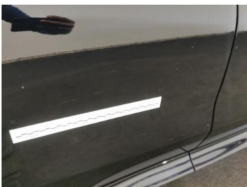
Fot. 43 Drzwi tylne P - Rysa/odprysk 1
