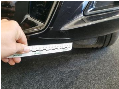
Fot. 41 Zderzak - Rysa/odprysk 1
