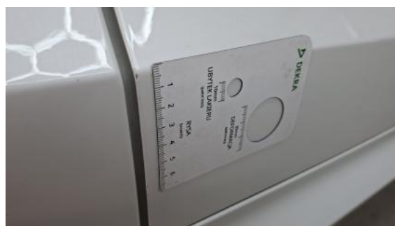
Fot. 52 Drzwi przednie P - Rysa/odprysk 1
