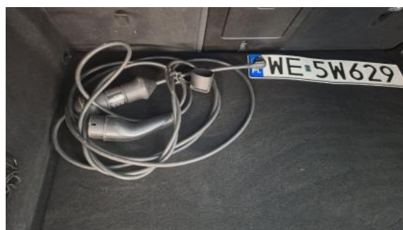
Fot. 28 Przewód ładowania baterii trakcyjnej
