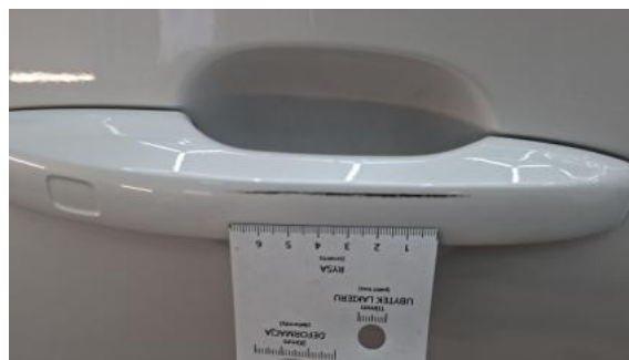
Fot. 54 Klamka drzwi tyl P - Rysa/odprysk 1
