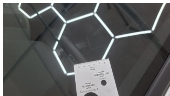
Fot. 40 Szyba czołowa - Rysa/odprysk 2
