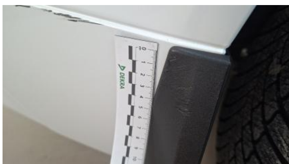
Fot. 63 Zderzak tylny cz P() - Rysa/odprysk 3
