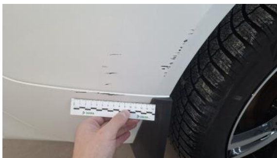
Fot. 61 Zderzak tylny cz P - Rysa/odprysk 1
