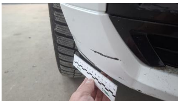
Fot. 47 Zderzak przedni cz P - Wgniecenie/odkształcenie 2
