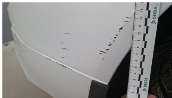
Fot. 62 Zderzak tylny cz P - Rysa/odprysk 2
