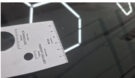
Fot. 39 Szyba czołowa - Rysa/odprysk 1
