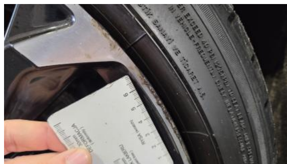
Fot. 38 Felga aluminiowa tylna P - Rysa/odprysk 1
