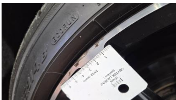
Fot. 35 Felga aluminiowa przednia P - Rysa/odprysk 2
