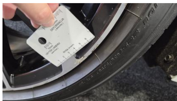
Fot. 40 Felga aluminiowa tylna P() - Rysa/odprysk 3
