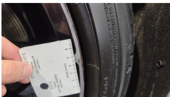
Fot. 39 Felga aluminiowa tylna P - Rysa/odprysk 2
