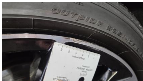
Fot. 34 Felga aluminiowa przednia P - Rysa/odprysk 1
