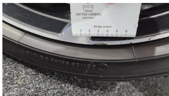
Fot. 36 Felga aluminiowa przednia P() - Rysa/odprysk 3
