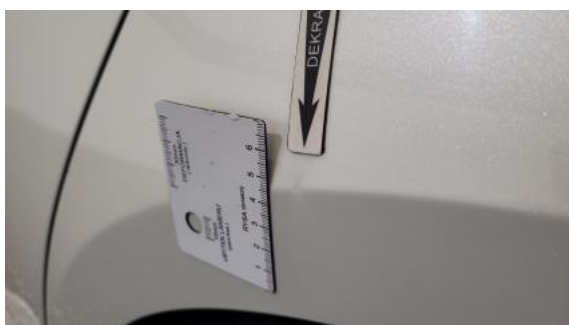
Fot. 43 Błotnik tylny L / Ściana boczna L - Wgniecenie/odkształcenie 1
