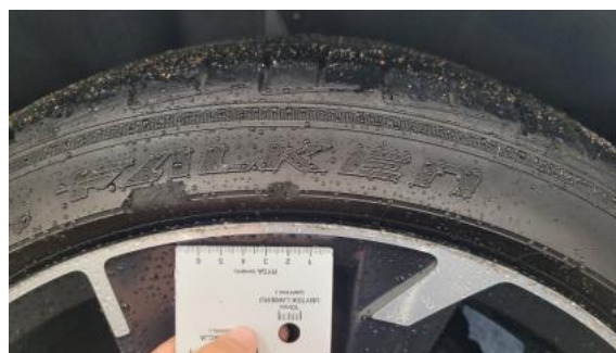
Fot. 46 Felga aluminiowa tylna L - Rysa/odprysk 2
