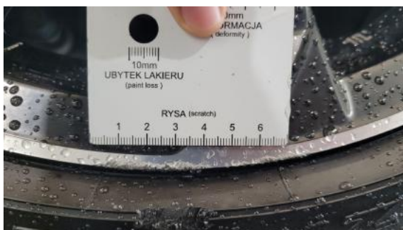
Fot. 45 Felga aluminiowa tylna L - Rysa/odprysk 1
