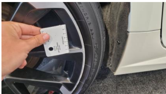
Fot. 41 Felga aluminiowa tylna P() - Rysa/odprysk 3
