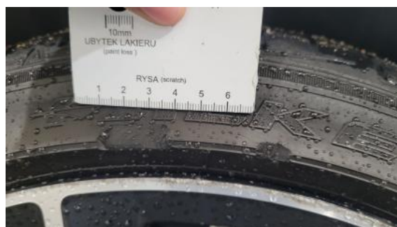
Fot. 48 Opona tylna L - Pęknięcie/rozerwanie 1
