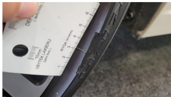
Fot. 42 Opona tylna P - Pęknięcie/rozerwanie 1
