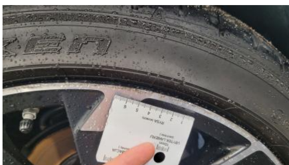
Fot. 47 Felga aluminiowa tylna L() - Rysa/odprysk 3
