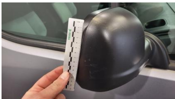
Fot. 37 Lusterko zew P - Rysa/odprysk 1
