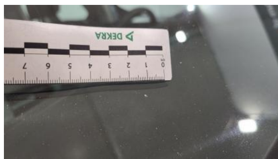
Fot. 32 Szyba czołowa - Rysa/odprysk 1
