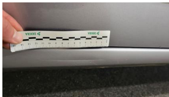
Fot. 38 Próg P - Wgniecenie/odkształcenie 1
