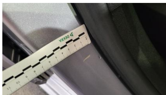
Fot. 40 Słupek środkowy P - Wgniecenie/odkształcenie 1
