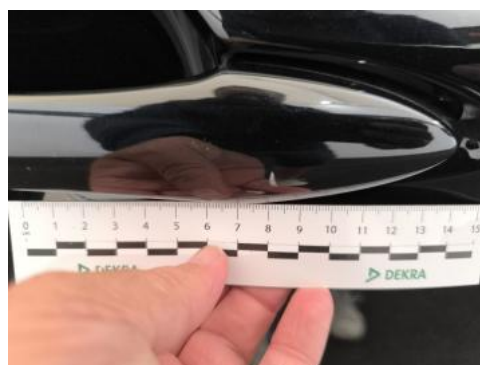
Fot. 38 Klamka drzwi prz P - Rysa/odprysk 1
