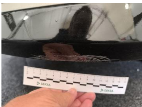
Fot. 35 Zderzak - Rysa/odprysk 1
