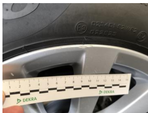
Fot. 46 Felga aluminiowa tylna L - Rysa/odprysk 1
