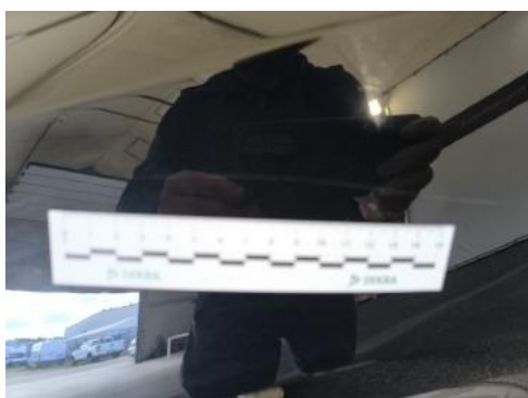
Fot. 53 Błotnik przedni L - Rysa/odprysk 1
