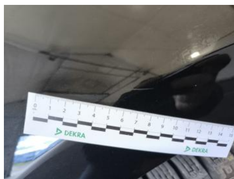
Fot. 54 Błotnik przedni L() - Rysa/odprysk 3
