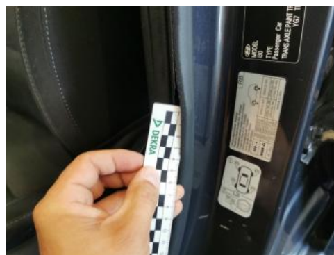
Fot. 60 Uszczelka drzwi przednich L - Pęknięcie/rozerwanie 1
