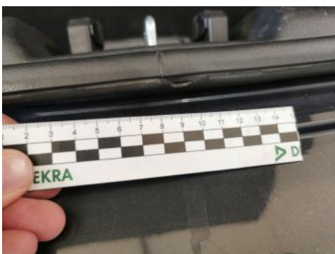
Fot. 63 Uszczelka pokrywy tylnej - Pęknięcie/rozerwanie 1
