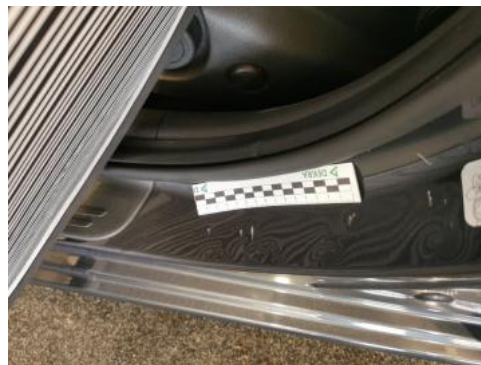
Fot. 58 Słupek środkowy L - Wgniecenie/odkształcenie 1
