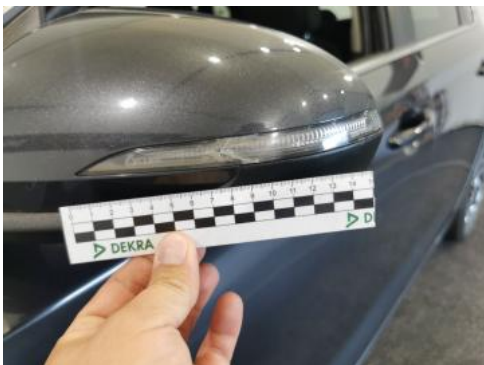
Fot. 57 Kierunkowskaz boczny/lusterka L - Pęknięcie/rozerwanie 1
